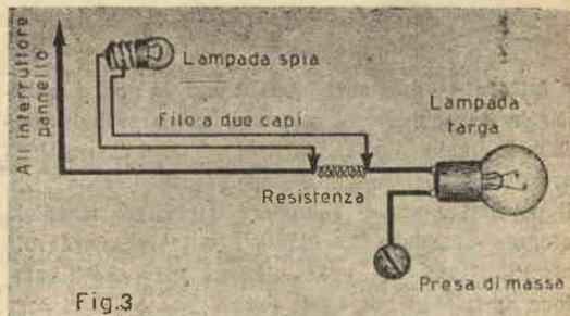
plicata nella testa del fanale. Occorre tener presente, durante il montaggio, che la lampadina spia sia isolata dalla massa metallica. Questo sarà possibile acquistando un portalamпада usato, oppure interponendo tra il portalamпада e la parte metallica della macchina due rondelle isolanti. Si potrà usare per isolante: legno - bachelite - gomma - celluloidi ecc.
