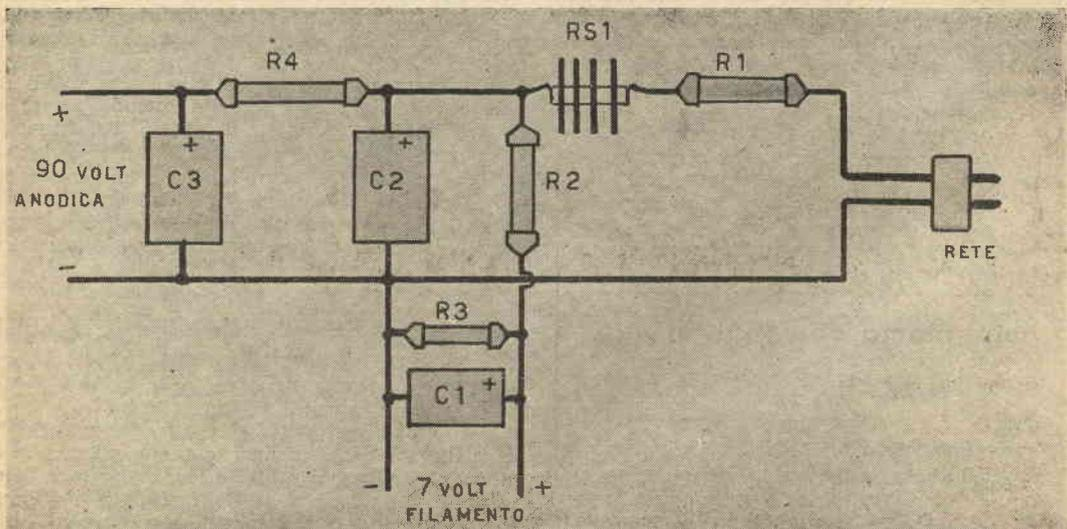
schema non viene usato nessun trasformatore di alimentazione, per abbassare la tensione della linea è ottenere così una tensione di 110 volt, necessaria per il raddrizzatore RS1, si inserisce una resistenza R1 che deve essere di 50 ohm 1 Watt per i 110 volt, 230 ohm 1 Watt per i 125 volt, 615 ohm 3 Watt per i 160 volt, 1700 ohm 8 Watt per i 220 volt.
