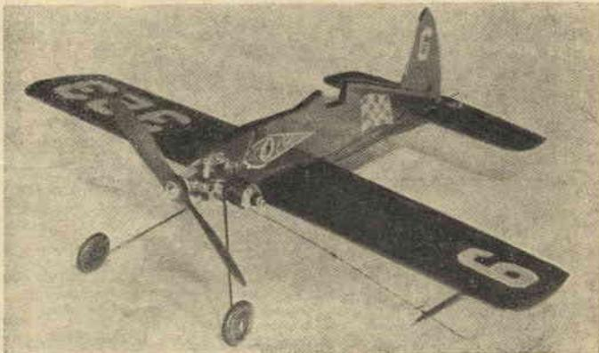
sa, mediante piccole cerniere di ottone fissate con piccoli rivetti. Nella parte mobile occorre collegare la squadretta o gancio che servirà a collegare mediante un filo d'acciaio da 1,5 mm., il timone alla leva di comando applicato sotto l'ala.
